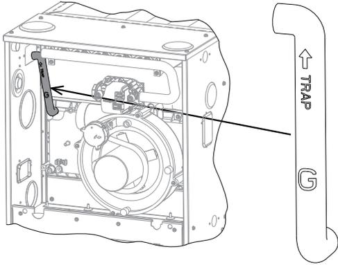
INSTALL HOSE G ON COLLECTOR BOX AS SHOWN.
