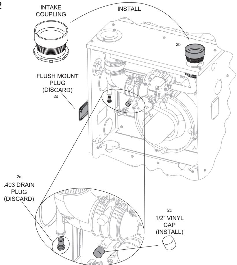
2a - REMOVE .403" DRAIN PLUG FROM FLUE ELBOW - DISCARD.
