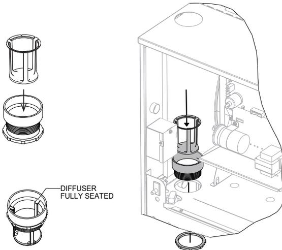
INSTALL INTAKE COUPLING IN BLOWER SHELF HOLE AS SHOWN.
