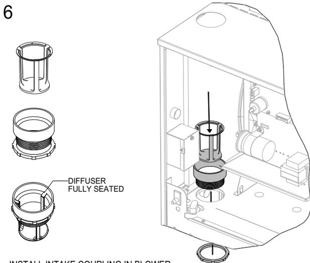
INSTALL INTAKE COUPLING IN BLOWER SHELF HOLE AS SHOWN.
